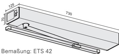
Bemaßung: ETS 42 mit Gleitschiene
