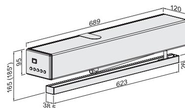
Bemaßung: ETS 73 / ETS 64-R mit Gleitschiene
