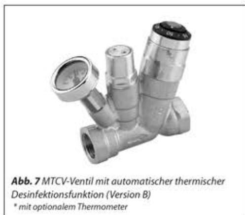
Das montierte Desinfektionsmodul öffnet automatisch einen Bypass von  $K_v \text{ min} = 0.15 \text{ m}^3/\text{h}$  für den Desinfektionsprozess-Durchfluss. Dieser Bypass ist in der Version A des MTCV immer geschlossen, um Kalk- und Schmutzablagerungen vorzubeugen. Das MTCV kann somit auch noch nach längerer Betriebszeit in der Version A um das Desinfektionsmodul ergänzt werden, ohne dass ein Blockierungsrisiko des Bypasses besteht.
