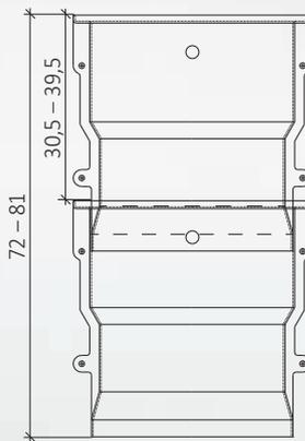
Verstellbereich bei Aufsatz mit Befestigungsösen
