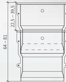
Verstellbereich bei Aufsatz mit abgeschnittenen Befestigungsösen
