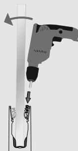
**7** Durch Eindrehen der Stiftschraube rechts drückt das Stellelement gegen die Scheibe und schiebt diese nach links.
