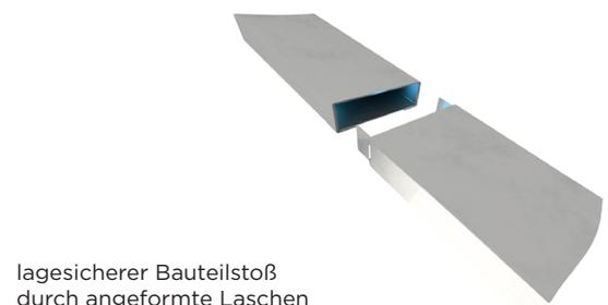
lagesicherer Bauteilstoß durch angeformte Laschen
