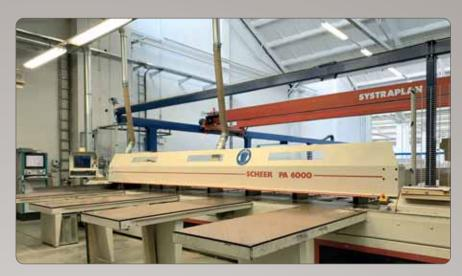
Mittels Portalkran werden die im Flächenlager gestapelten Verbundelemente der Säge zugeführt.
