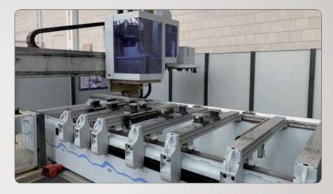
Am Bearbeitungszentrum werden die Platten mit Ausschnitten oder Bohrungen versehen. Kanten können hier auch sauber gefräst werden.
