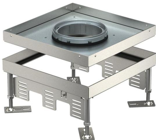
Nivellierbare Kassette der Nenngröße 9 für Tubus für den Einbau von Installationsgeräten in trocken oder nass gepflegten Fußböden im Innenbereich. Nivellierbare Kassette mit Tubus, 3-zügig. Es können 3 Abdeckplatten APMT5 installiert werden. Für den Einbau von 3 Universalträgern UT4 für 6 Einzel-Installationsgeräte mit Tragering/Tragebügel oder 6 Modul 45-Geräte.
