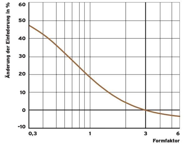
Abb. 6: Einfeldung<sup>4</sup> bei gleichbleibender Dicke in Abhängigkeit des Formfaktors
