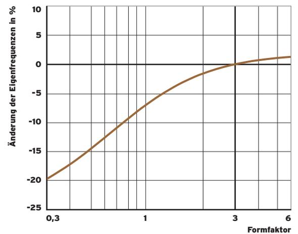
Abb. 8: Eigenfrequenz<sup>4</sup> bei gleichbleibender Dicke in Abhängigkeit des Formfaktors
