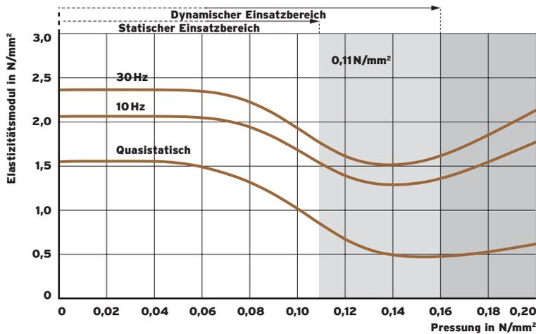
Abb. 2: Belastungsabhängigkeit des statischen und dynamischen Elastizitätsmoduls
