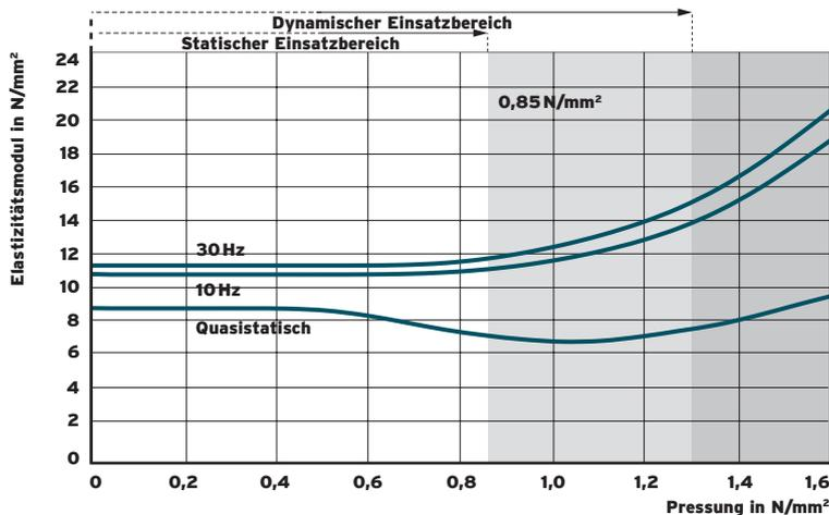
Abb. 2: Belastungsabhängigkeit des statischen und dynamischen Elastizitätsmoduls
