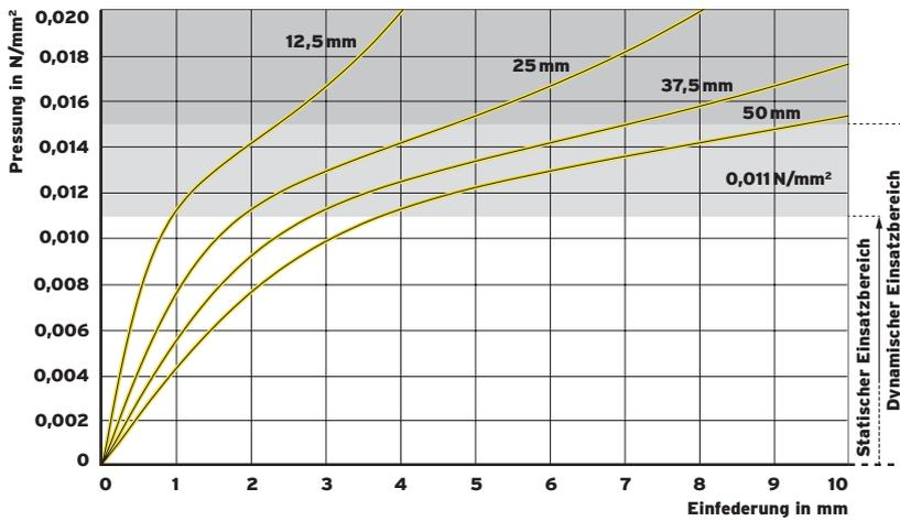
Abb. 1: Quasistatische Federkennlinie für verschiedene Lagerdicken
