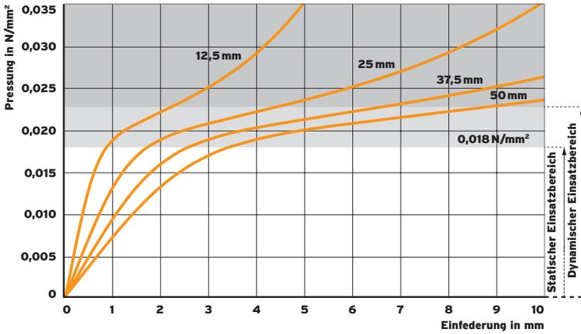
Abb. 1: Quasistatische Federkennlinie für verschiedene Lagerdicken
