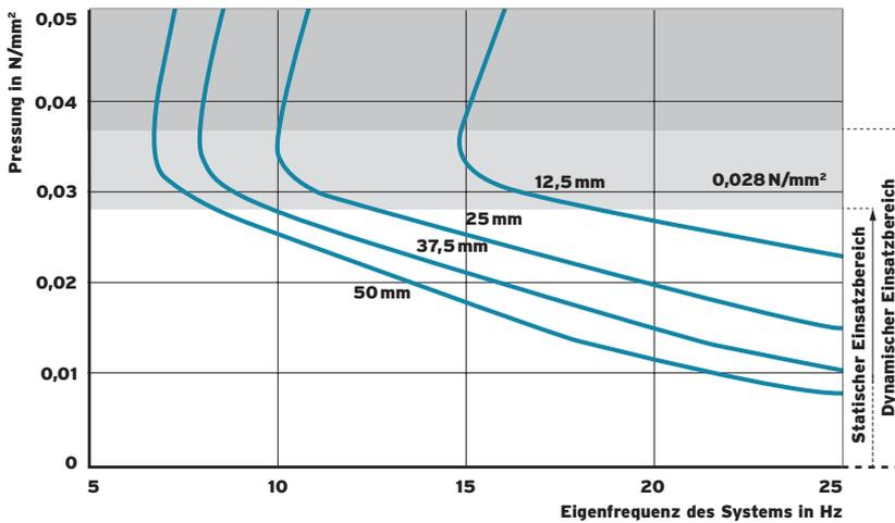
Eigenfrequenzen eines schwingungsfähigen Systems mit einem Freiheitsgrad, bestehend aus einer starren Masse und einem elastischen Lager aus Sylomer® SR28 auf starrem Untergrund.
