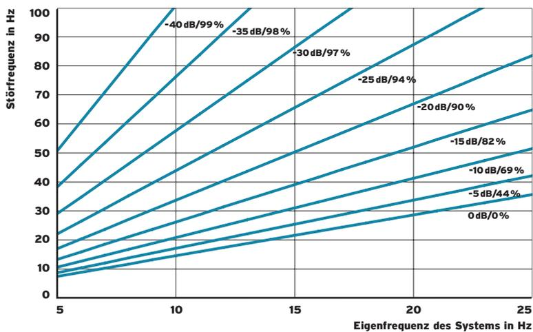
Verminderung der Übertragung mechanischer Schwingungen durch den Einbau einer elastischen Lagerung aus Sylomer® SR28 auf starrem Untergrund.
