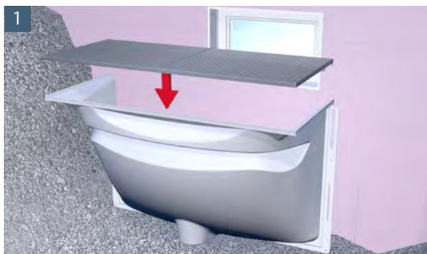
Rost in Lichtschacht einlegen. Die Abhebesicherungsketten an den beiden gelochten Tragstäben einhängen und mit den mitgelieferten Schrauben (mit 4 mm Bohrer vorbohren) am Lichtschacht möglichst weit oben befestigen.
