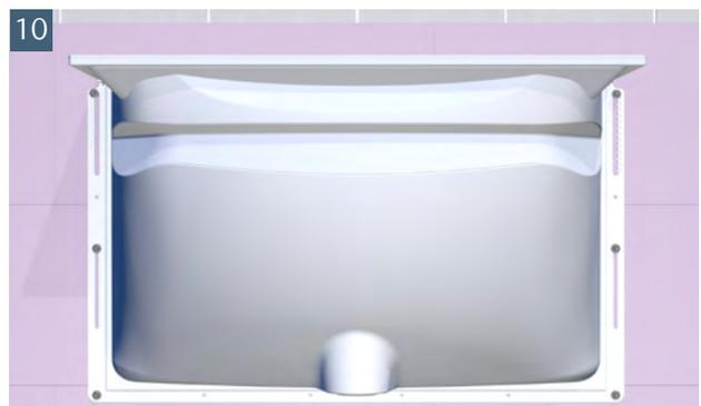
10 Entwässerungsanschluss oder Rückstauverschluss an Entwässerungsleitung anschließen.
