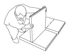
2) Mittelboden in die Nut der Seitenwand einstecken. Bündigkeit zwischen Mittelboden und Seitenwand prüfen.
