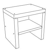
8) Der Waschtisch ist jetzt fertig und kann, nachdem der Montagekleber ausgehärtet ist (ca. 24 Stunden), direkt befliest, verspachtelt oder verputzt werden. Um eine feste Position zu garantieren, muss der Waschtisch an Wand und Boden mit BOARD-FIX® angeklebt werden. Bitte beachten Sie die folgenden Hinweise.
