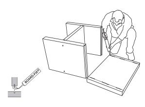
4) Kleber wird an beiden Fügeteilen (Tischplatte und Seitenwände) aufgetragen.
