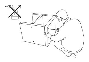
6) Der Waschtisch wird zusammengeschraubt. Hierfür werden die Schrauben unter Verwendung der Beilagscheiben an allen vorgebohrten Löchern angeordnet. Die Schrauben werden mit einem Handschraubendreher soweit angedreht, dass der Schraubenkopf bündig mit der Oberfläche abschließt.
