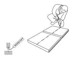
1) Kleber wird an beiden Fügeteilen (Seitenwände und Mittelboden) aufgetragen.
