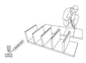
4) Kleber an beiden Fügeteilen (Seitenwand und Regalböden) auftragen.
