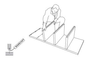
3) Regalböden werden der Reihe nach eingeklebt. Passend zum Waschtisch, wird der Regalboden in 80 mm Dicke an zweiter Position von unten angeordnet.
