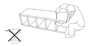
6) Beide Seitenwände des Regals werden mit den beiliegenden Schrauben unter Verwendung der Beilagscheiben an den vorgebohrten Stellen zusammengeschraubt. Hierbei werden die Schrauben mit einem Handschraubendreher soweit angedreht, dass der Schraubenkopf bündig mit der Oberfläche abschließt.
