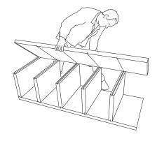
5) Zweite Seitenwand auflegen, so dass jeweils die Feder in der Nut sitzt. Bündigkeit zwischen Seitenwand und Regalböden prüfen.
