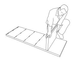
2) Regalboden in die Nut der Seitenwand einstecken. Bündigkeit zwischen Regalboden und Seitenwand prüfen.
