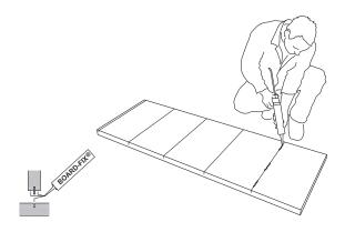
1) Kleber wird an beiden Fügeteilen (Seitenwand und Regalboden) aufgetragen.
