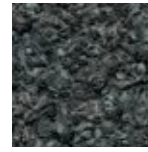
Basaltbeton ausgewaschen a)
