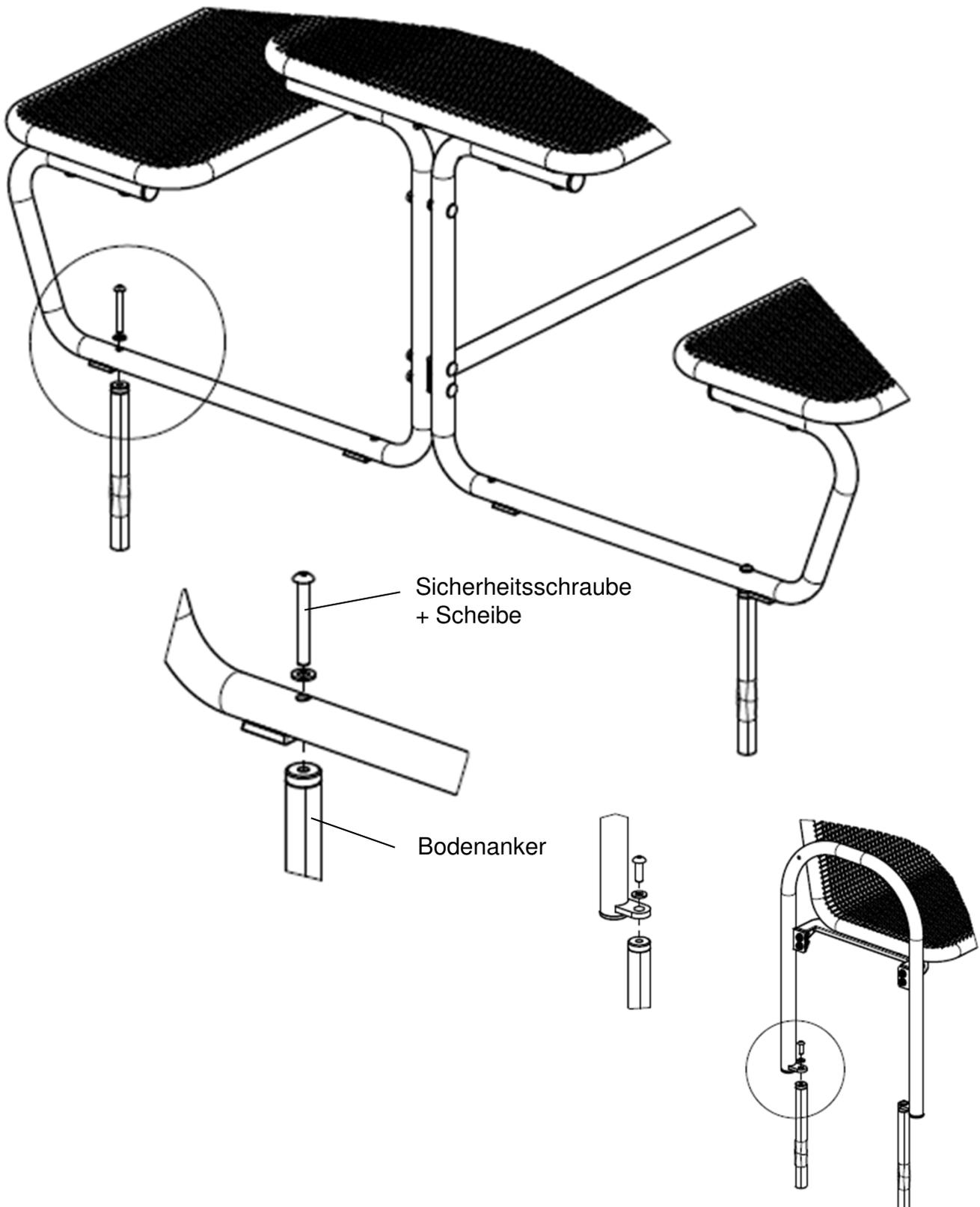
Anziehdrehmoment A2-70 Schrauben: M6 – 6 Nm, M8 – 16 Nm, M10 – 32 Nm. Auf festen Sitz der Verschraubungen achten! Um ein „Fressen“ vom Gewinde zu verhindern, kann eine aufgesprühte PTFE-Trockenschicht verwendet werden.
