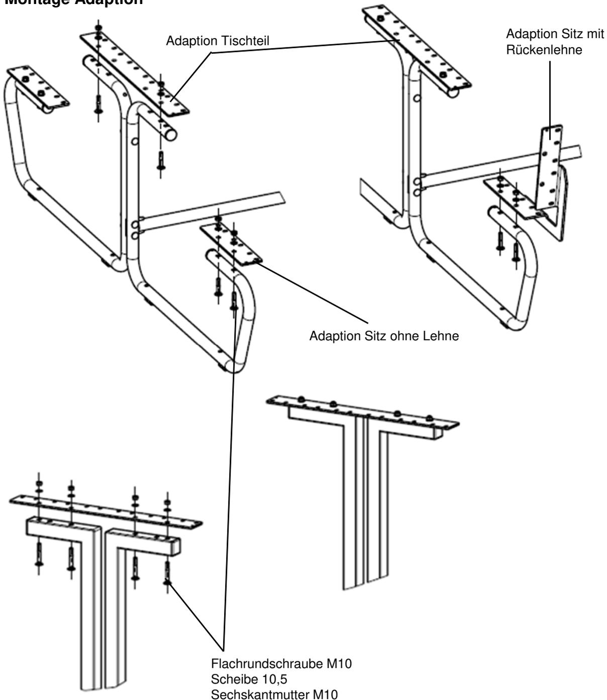
Anziehdrehmoment A2-70 Schrauben: M6 – 6 Nm, M8 – 16 Nm, M10 – 32 Nm. Auf festen Sitz der Verschraubungen achten! Um ein „Fressen“ vom Gewinde zu verhindern, kann eine aufgesprühte PTFE-Trockenschicht verwendet werden.
