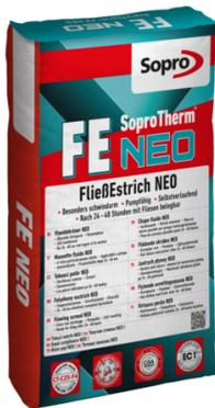
Trockenfertigmischung zur Herstellung besonders schwindarmer und früh belegereifer Zementfließestriche. Güteklasse CT-C25-F4 nach DIN EN 13813. Geeignet für beheizte und unbeheizte Estriche im Verbund, auf Trenn- oder Dämmschicht. Für die nachfolgende Verlegung von Bodenbelagsbaustoffen aller Art. Insbesondere für zeitsparende bzw. termingebundene Estricharbeiten.
