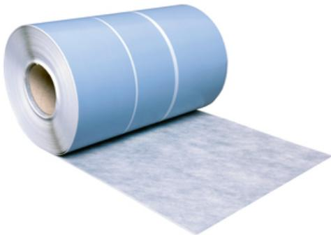
**Selbstklebendes, vlieskaschiertes Dichtband aus Butylkautschuk. Zur flexiblen und wasserundurchlässigen Überbrückung von Anschluss- und Bewegungsfugen zwischen Bodenplatte und Mauerwerksschichten, zwischen Kelleroberkante/Bodenplatte und nachfolgendem Fertighausbau und für Bewegungsfugen allgemeiner Art. Zum Überbrücken von Anschlüssen bei Materialwechseln z. B. Mauerwerk auf Holz oder Trockenbau.**
