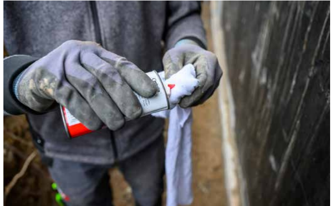
Wischprüfung mit weißem Tuch und Benzin.
